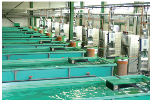
10 Kreislaufanlagen mit „Stofftrennung“ über Membrantechnik
