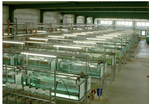
Pilotprojekt „Abwasserfreie Aquakulturanlage“ in Thierbach - Linie von 6 Aufzuchtanlagen
